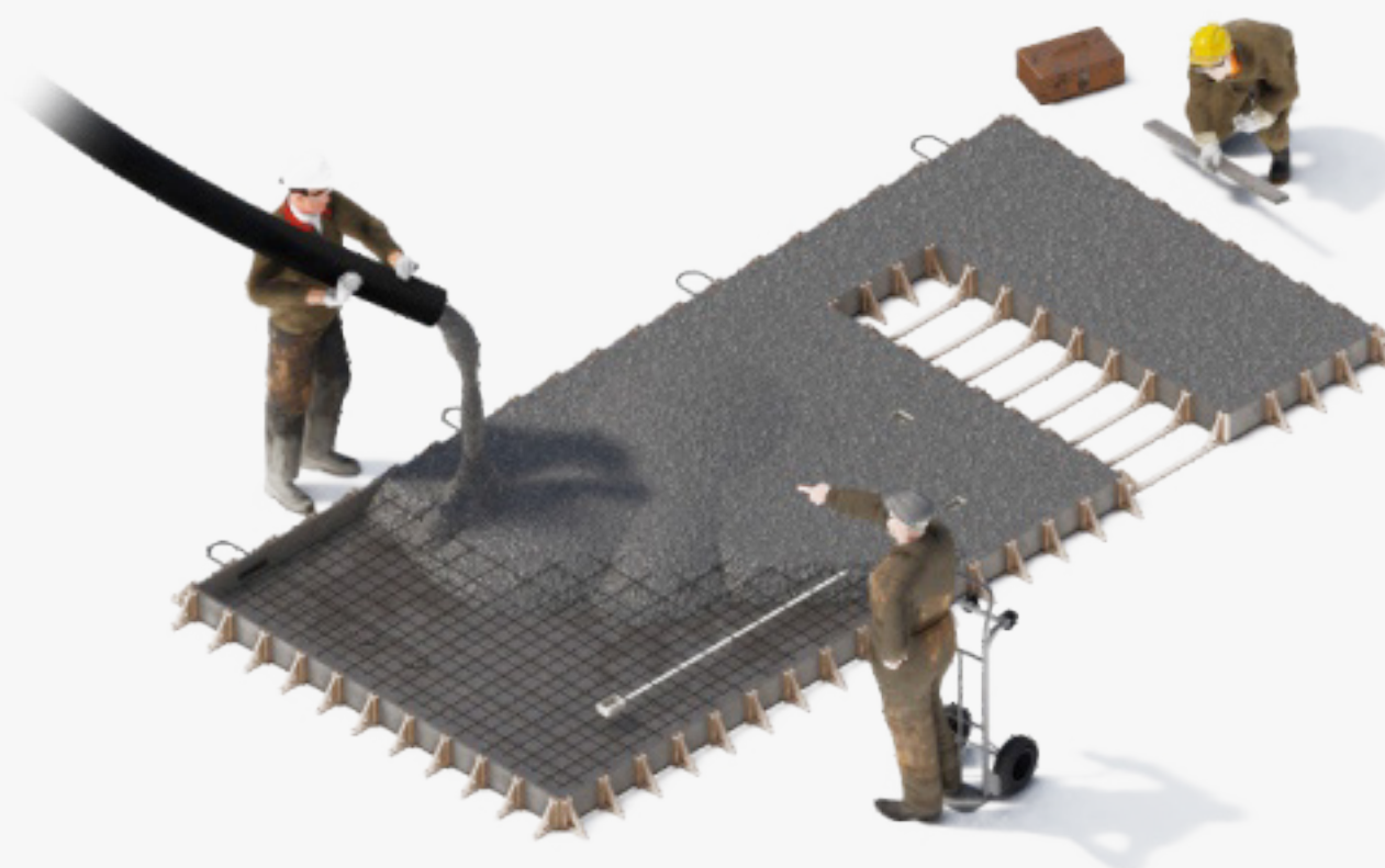
2. COLADO DEL HORMIGÓN
