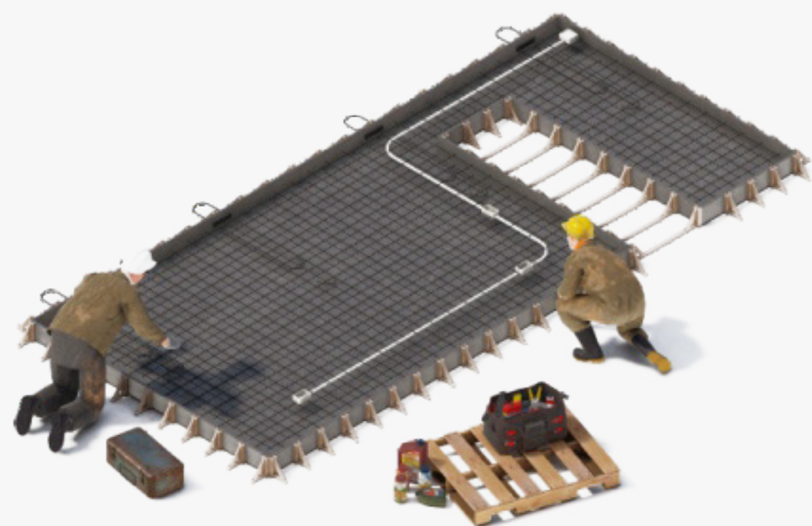
1. ENCOFRADO, ARMADURA E INSTALACIONES
